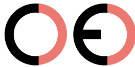
Faux marquage CE (trop éloignée)
